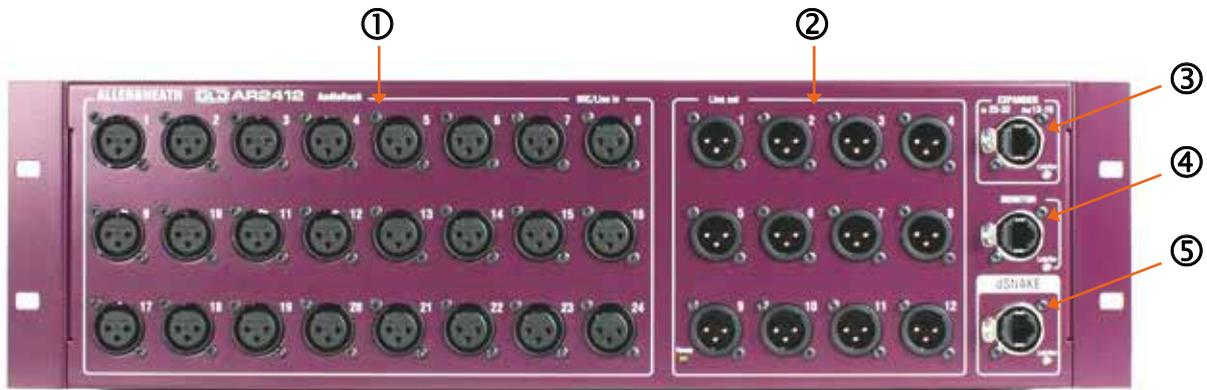
**① 输入接口** 24 路平衡 XLR 输入，用于话筒和线路电平音源。AR2412 机架内置前级放大器，可通过 dSNAKE 连接在 GLD 调音台上对它们的增益、定值衰减和 48V 幻象电源进行远程控制。模拟前级放大器的输出转化为数字格式，然后通过 dSNAKE 传送到 GLD 调音台进行处理和混音。
