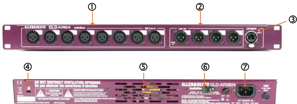
① **输入接口** 8路平衡 XLR 输入，用于话筒和线路电平音源。AR2412 机架内置前级放大器。可通过 dSNAKE 连接在 GLD 调音台上对它们的增益、定值衰减和 48V 幻象电源进行远程控制。模拟前级放大器的输出转化为数字格式，然后通过 dSNAKE 传送到 GLD 调音台进行处理和混音。
