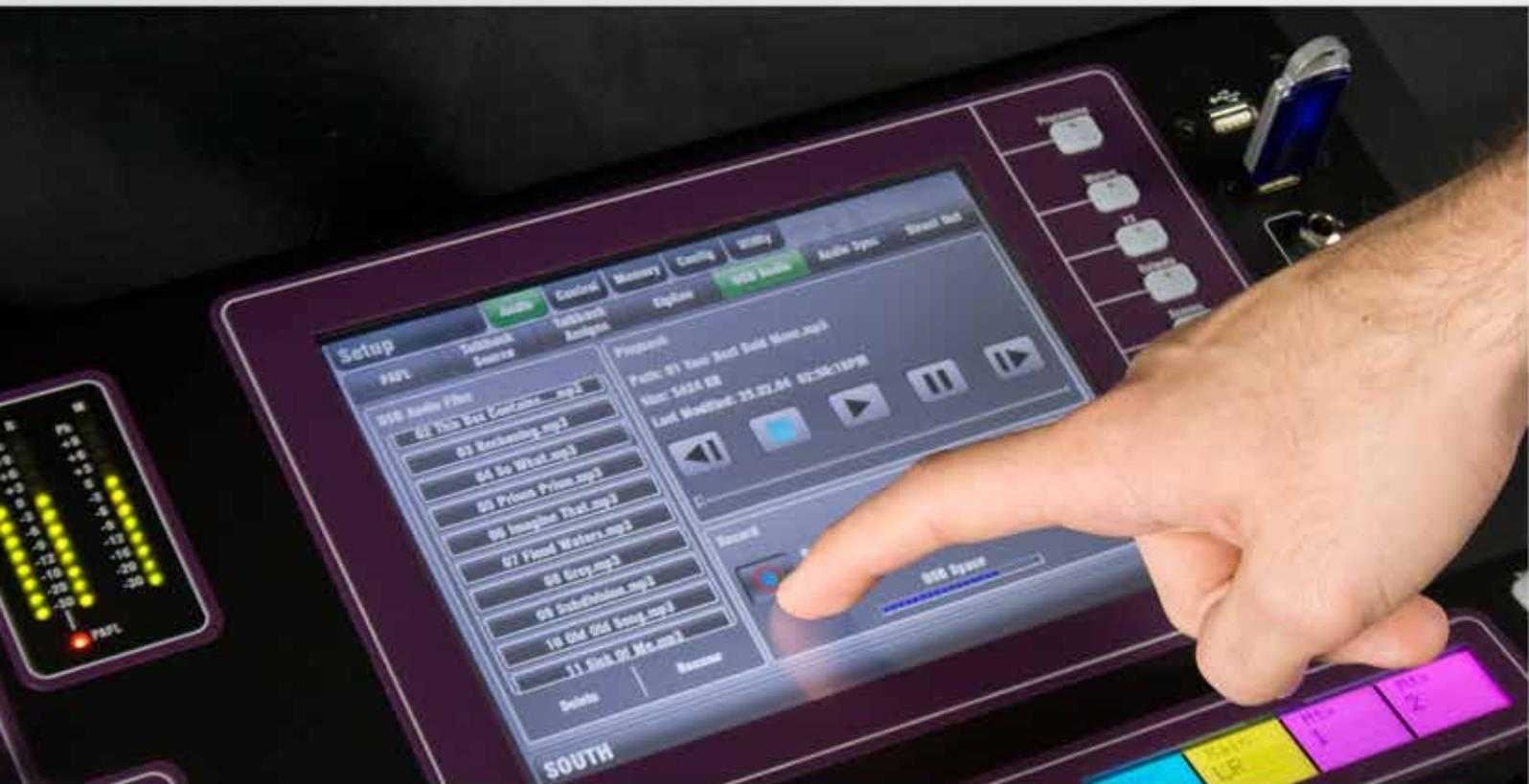
可对任何音源或混音母带进行双轨 WAV 格式的录音
