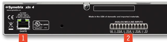
**1** Dante (Primary): 100 Base-T以太网端口提供8个 (4x4) Dante网络音频、以太网通信和电源的通道。
