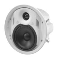
音箱发货时,面板内部的传感器由可 拆的纸质包装。纸质包装一方面用以 防止驱动在安装过程中受损,另一方 面方便涂漆以搭配室内装修风格。随 货提供粉末涂层的穿孔钢网罩,分频 选择器和全频/高通按钮一经设定, 音箱即可安装,且安装简易。
