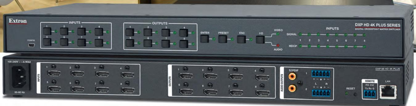
Extron DXP HD 4K PLUS 系列高性能 HDMI 矩阵切换器符合 HDCP 2.2 标准, 适用于分辨率高达 4K/60、带 4:4:4 色度取样的计算机和视频信号。它们支持 HDMI 2.0b 参数标准, 包括高达 18 Gbps 的数据速率、HDR、高达 12 位的色深、3D 和高清无损的音频格式。该系列产品集成包括 SpeedSwitch®、EDID 管理器 (EDID Minder®)、密钥管理器 (Key Minder®) 以及 HDMI 输入均衡和输出时钟恢复在内的 Extron 技术, 以确保可靠的系统操作。为了简化集成, 可将任一输入的数字音频进行解嵌, 通过数字或模拟立体声端口输出。DXP HD 4K PLUS 系列提供 4x4、8x4 和 8x8 不等的尺寸, 非常适用于需要对 4K/60 HDMI 视频和音频信号进行可靠、高性能的矩阵切换的应用环境。
