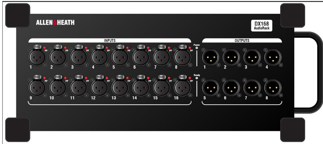
① 输入插座 16 个平衡 XLR 话筒/线路输入及+ 48V 幻象电源指示灯。前置放大器内置 DX168 及其增益, Pad 和+ 48V 幻象电源由通过 DX 链接的 dLive 控制。模拟前置放大器输出转换为数字格式, 通过 DX 传送到 dLive 系统中进行处理和混音。插座编号为 1-16。在 dLive 系统上, 任意输入可跳接至控制台的任意通道。PP 指示灯 LED 检测插座上由 DX168 提供或从外部接收的电压。
