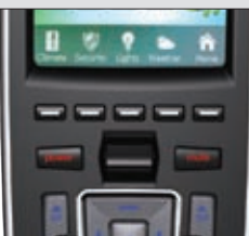
T3-V+ 无线界面 • 触摸屏下方的五个“多用途”按键键帽。
