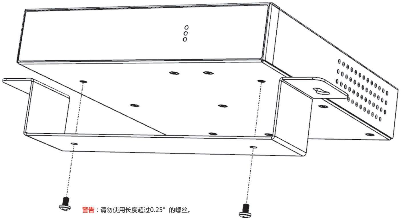
注意：1/2机架单元表面安装支架的设计适合美制10号木螺丝。
