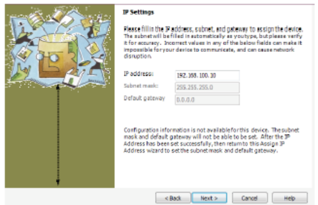
图 6: 选择与您个人电脑兼容的 ID 地址和子网掩码。不强制输入网关地址, 点击下一步。
