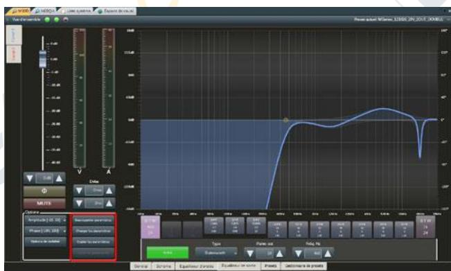
图 33： 输出均衡，有 4 种可能的替代选择可处理曲线。
