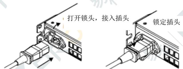
图 10: 交流电源插头连接
